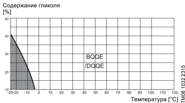
Рис. 33 Рабочий диапазон уплотнений вала из EPDM
