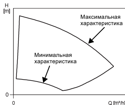
Рис. 53 Мин. и макс. характеристические кривые рабочих точек
