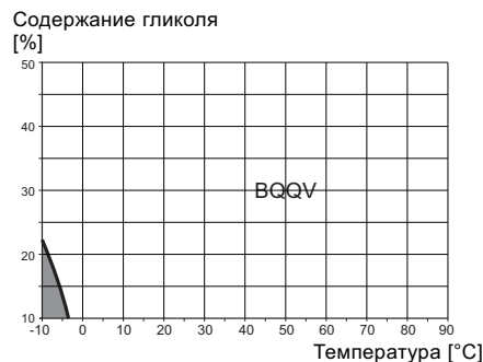
Рис. 34 Рабочий диапазон уплотнений вала из FKM
